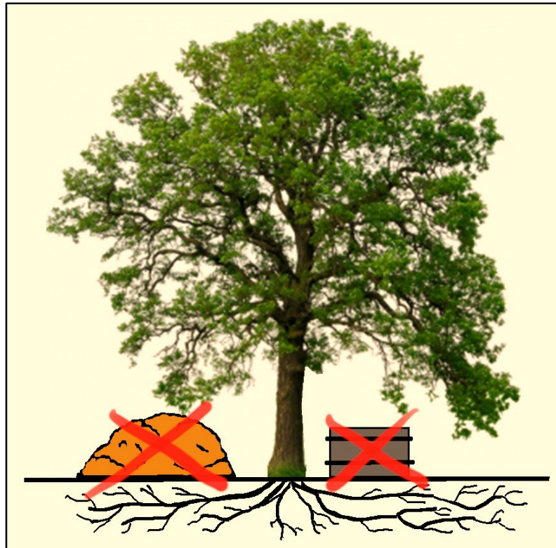
Ryc. 6. Zakaz składowania nadkładu i/lub materiałów budowlanych w SOD
